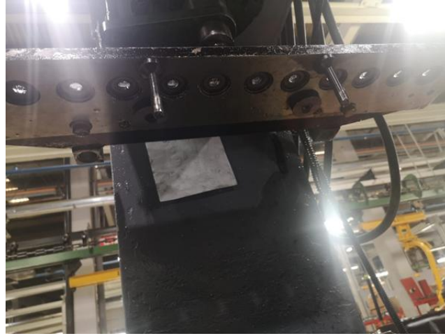
Şekil 7. Silindir kapak subap pres işleminde kullanılan eski pres aparatının aşınmış görüntüsü Figure 7. Worn image of the old press apparatus used in cylinder head valve pressing process
