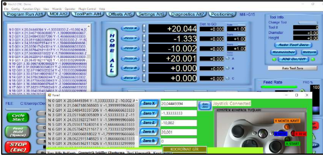
Şekil 8. C# editöründe yazılan arayüz programında, Joystick ile kontrol için hazırlanmış G kodlarının bir kısmı ve Mach3 programındaki görüntüsü
