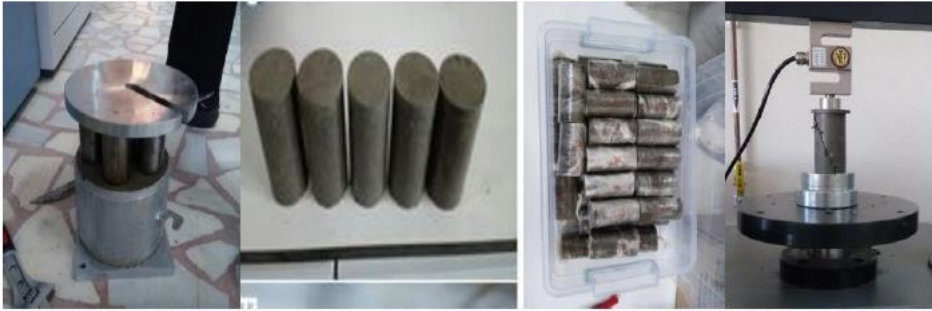
Fotoğraf 1. Optimum su muhtevalarında serbest basınç deneyi için numune hazırlanması, kür edilmesi Totiç ve ark. (2019)
