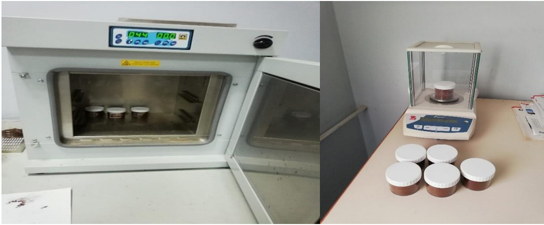
Şekil 2. Etüvde kurutulan ve ağzı kapatılan numunelerin tartılması
