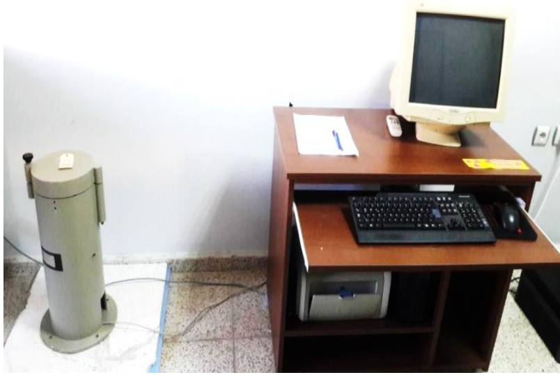
Şekil 3. NaI Sintilasyon dedektörünün kurşun zırhı ve bilgisayar bileşenleri
