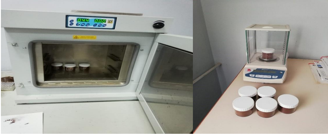
Şekil 2. Etüvde kurutulan ve ağzı kapatılan numunelerin tartılması
