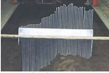
Şekil 15. Kulaklı pulluğun deneysel ve simülasyon sonucu elde edilen toprak yüzeyi pürüzlülük ölçümü ve karşılaştırması (Üçgül ve ark. 2018)
