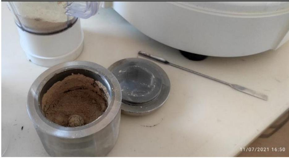
Şekil.1. Biyonanokompozitin Bilyeli değirmende öğütülmüş hali
